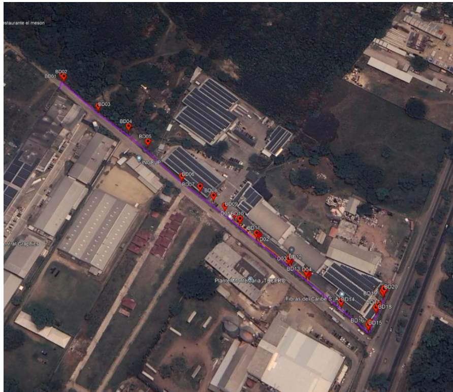
Imagen 19: Extensión de línea primaria para la unificación de medida entre DINAPLAST y BONISA.
