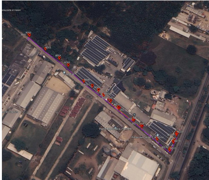
Imagen 14: Extensión de línea primaria para la unificación de medida entre DINAPLAST y BONISA.
