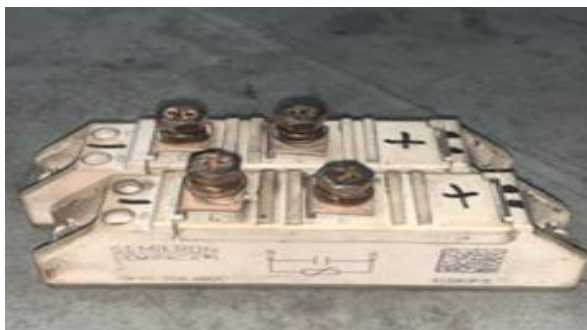
Figura 12 Fotografía de varistores con indicios de fallas de la U3 (fuente reporte de falla GEN U3 17 de junio, Mantenimiento Eléctrico La Ensenada)
