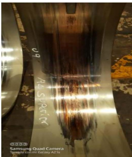
Casquillos de biela donde se muestra el daño
