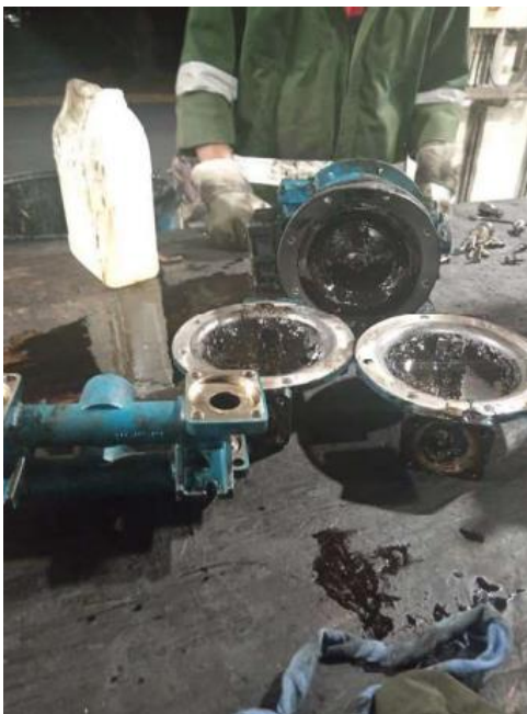
Figura 43 Daños en bombas de lodos de patines de separadoras HFO y tuberías completamente obstruidas por lodos solidificados en partes internas
