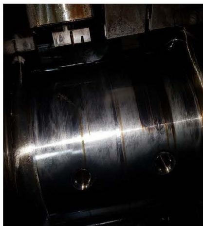
Muñón de cigüeñal donde se muestra el daño
