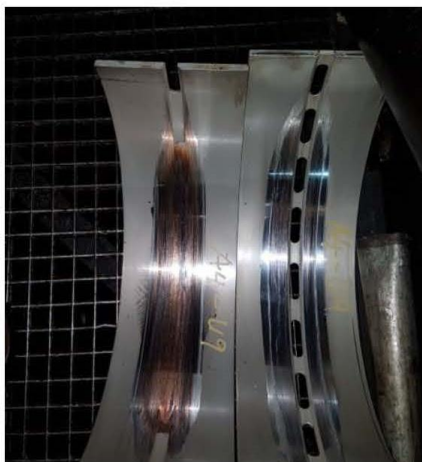
Casquillos de biela donde se muestra el daño
