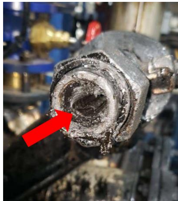
Figura 43 Daños en bombas de lodos de patines de separadoras HFO y tuberías completamente obstruidas por lodos solidificados en partes internas
