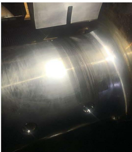
Muñón de cigüeñal donde se muestra el daño
